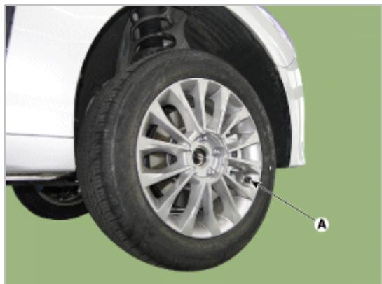
拆卸前车轮和轮胎 (A) 时，小心不要损坏轮毂螺栓。
