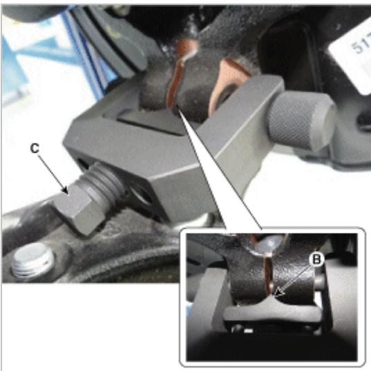
5. 拧下稳定杆固定螺母(A)，并从减振器上拆下稳定杆。
