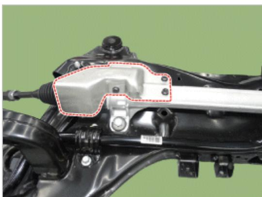
12. 拧下固定螺栓，从副车架(A)上拆卸稳定杆(B)。
